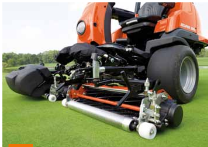
Eclipse 322 - jediná zcela hybridní třívřetenová sekačka greenů. Plná kontrola FOC, bez nebezpečí úniku hydraulického oleje
