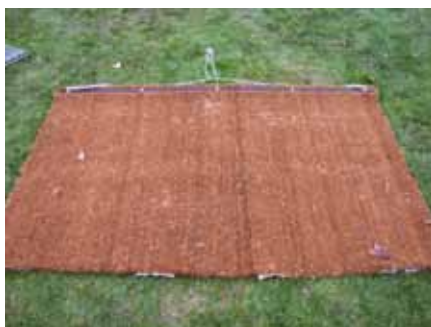
Nová smykovací rohož z kokosových vláken pro velmi jemné zapravení písku
